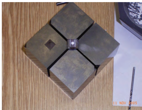
Rys. 10.16. Układ wewnętrznych kowadłał w prasie MAX200x. Widoczne są cztery dolne oraz ośmiościenna próbka umieszczona pomiędzy nimi [22] (fot.: Christian Lathe)
