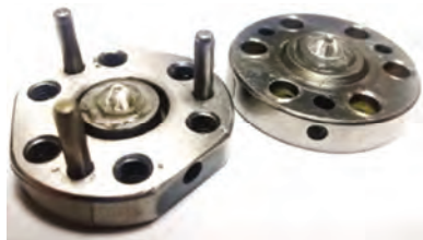
Rys. 10.8. Rozłożona komora prostej konstrukcji (miniDAC firmy D'Anvils). Średnica komory wynosi 2 cm
