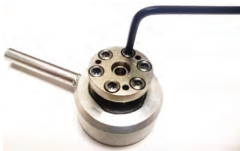
Rys. 10.10. Redukcja odległości pomiędzy kowadłami dla miniaturowej komory ciśnieniowej (producent: D'Anvils). Zmiana odległości kowadeł o kilka mikrometrów dokonywana jest poprzez dokręcenie sześciu (w danym przypadku) śrubek o kąt wynoszący kilka stopni, co zapewnia zmniejszenie dystansu między kowadłami o pojedyncze mikrometry
