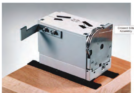
Rys. 9.5. Zdjęcie monochromatora symetrycznego 4xGe(220) z e szczelinami formującymi wiązkę. Zdjęcie pochodzi z Empyrean User Guide.pdf
